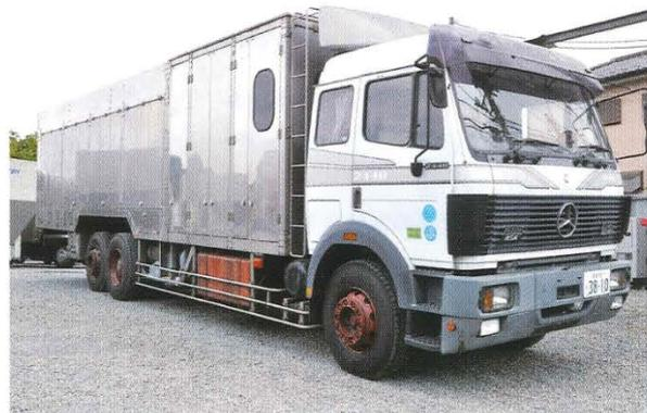
発電設備が定格通りの電力を発電しているかチェックする負荷試験装置車もラインアップ。移動電源車とコンビで出動することもあるという。
